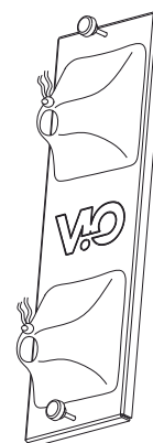
RC-X3 Regenschutz für die Endstufensektion.
