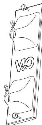
RC-X3 protección antilluvia para la sección amplificador.
