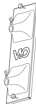
RC-X3 protezione anti-pioggia per la sezione amplificatore.
